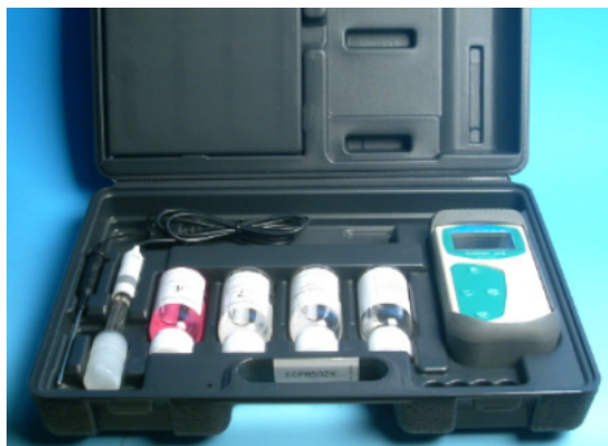
Pour analyses physico-chimiques : kit de mesure de pH + conductivité + pO 2 , verrerie
