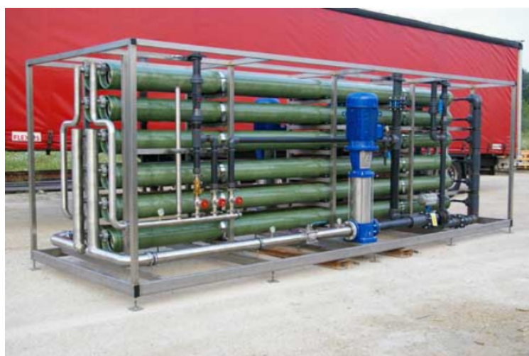
Unité d'osmose inverse gros débit
