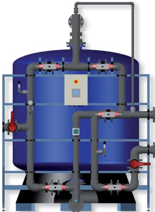
Décolmatage à l'eau brute
